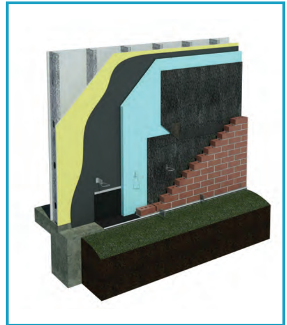
Pared de montaje metálico DriPlane con enchapado de ladrillo
