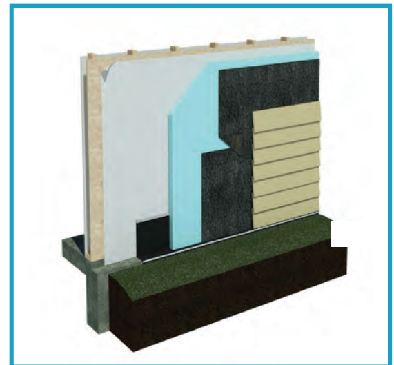
Pared de montaje de madera DriPlane con revestimiento de cemento
