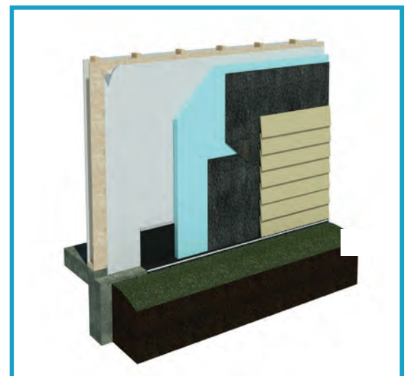
Pared de montante de madera DriPlane con revestimiento de cemento
