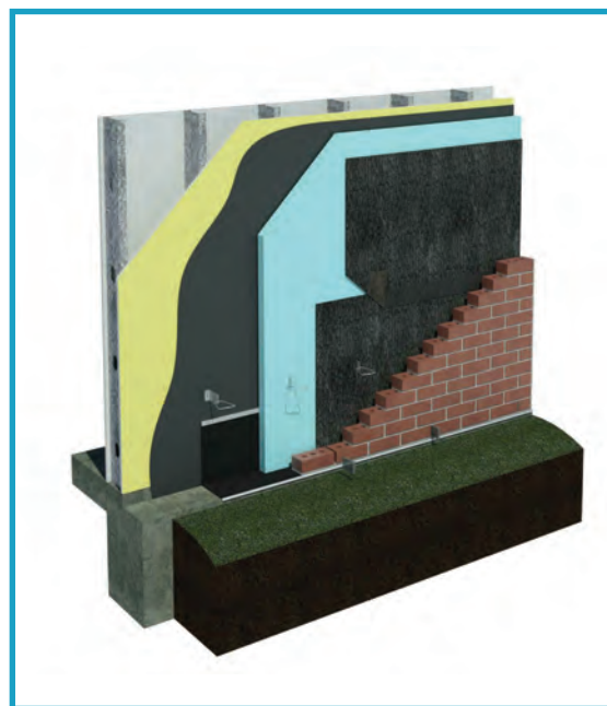
Pared de montaje metálico DriPlane con enchapado de ladrillo
