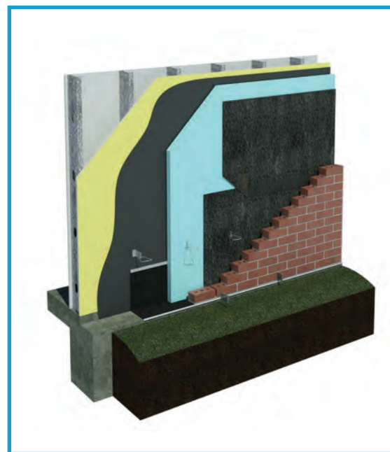
DriPlane – ściana na konstrukcji stalowej z powłoką ceglana
