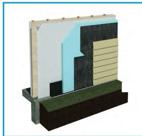
DriPlane – ściana na konstrukcji drewnianej z panelami betonowymi
